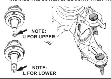
INSTALL THE LOWER "L" BALL JOINT AND THEN THE UPPER "U" BALL JOINT.
