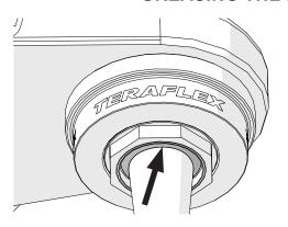
NOTE: GREASE BOTH UPPER AND LOWER BALL JOINTS AT EVERY OIL CHANGE INTERVAL.
