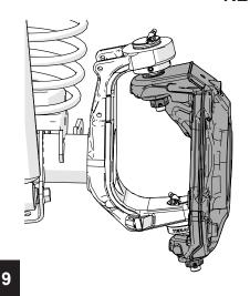
INITIALLY TIGHTEN LOWER BALL JOINT NUT TO 15 FT-LBS.
