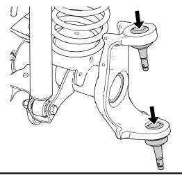
USING A BALL JOINT PRESS REMOVE THE UPPER THEN THE LOWER BALL JOINTS.
